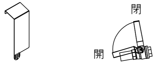
カス受け (槽の排油口に取り付け) 排油レバーの開閉の動き 垂直方向の動き
